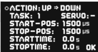
Im Experten Menü ist man mit dem Doorsequenzer nicht an festgelegte Modi gebunden, die den Piloten zum Fahrwerk Ein- und Ausfahren an fest vorgegebene Vektoren binden.
