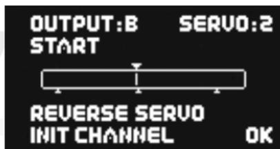
Zu sehen sind der graphisch dargestellte Ausgangsblock, die Kennung des Ausgangs und die zugeordnete Funktion des Ausgangs.
