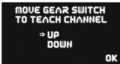
Die **PowerBox** detektiert den Schalter automatisch, sobald Sie am Sender den Schalter betätigen, den Sie für das Fahrwerk zugeordnet haben. Auf dem Bildschirm sollten die Pfeile vor **UP/DOWN** springen. Sollte ihr Fahrwerkschalter jetzt in der Richtung falsch sein, ändern Sie das, indem Sie im Sender den Ausgang umpolen.
